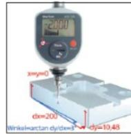
Bestimmung und Korrektur der Werkzeugausrichtung
